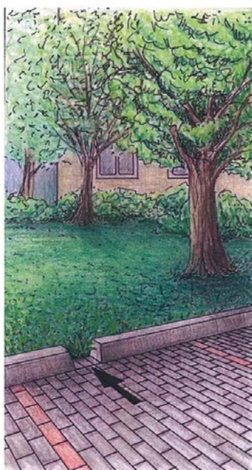
Rys. 13. Proste rozwiązanie umożliwiające odpływ wód opadowych ze szczelnej powierzchni na teren porośnięty roślinnością
