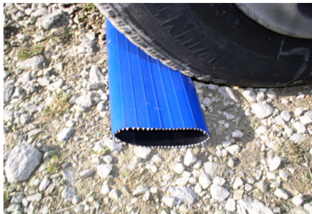
Fot. 65. Przewody typu Lay Flats . (W. Treder)
