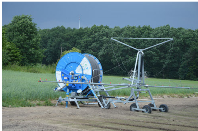
Fot. 45. Konsolowa deszczownia szpulowa. (W. Treder)
