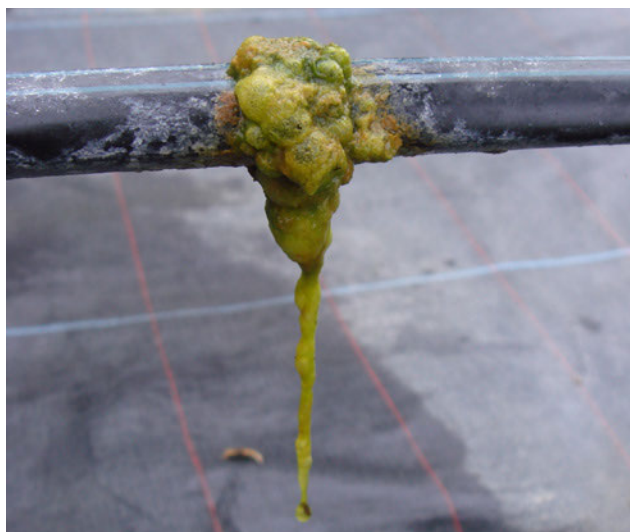
Fot. 21. Glony rozwijające się na wylocie z emitera kropłowego. (W. Treder)
