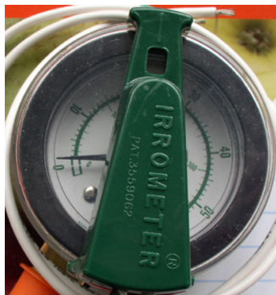
Fot 70. Tensjometr z wakuometrem do sterowania nawadnianiem przy określonym poziomie siły ssącej gleby. (W. Treder)
