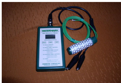
Fot. 71. Miernik potencjału wodnego gleby wraz z czujnikiem opornościowym.
