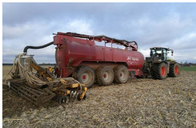
Fot. 6.8. Iniekcja doglebowa aplikatorem talerzowym (autor: K. Bąk)
