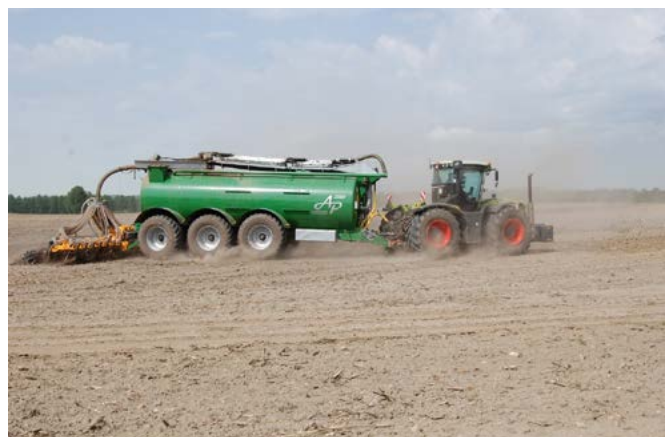
Fot. 6.7. Iniekcja doglebowa aplikatorem dłutowym (autor: K. Bąk)
