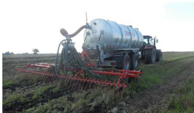
Fot. 3.4. Rozlewanie zakwaszonej gnojowicy na polu (autor: M. Sękowski)
