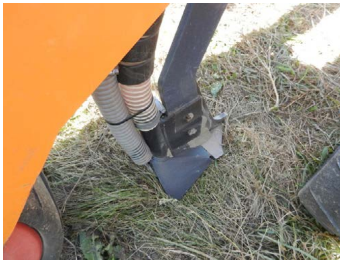
Fot. 3.3. Redlica do równoczesnego siewu i nawożenia (autor: M. Krysztoforski)
