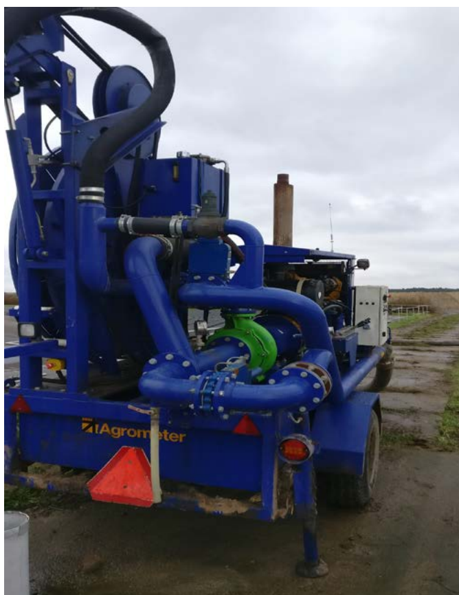
Fot. 6.10. Pompa spalinowa do dystrybucji, pracująca na gnojowicy (autor: K. Bąk)
