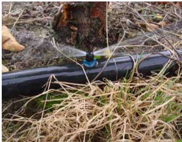
Fot. 6. System podkoronowego mini-zraszania powierzchni gleby tylko w pobliżu roślin za pomocą wykonanych z tworzywa minizraszaczy o wydatku od 20 do 200 l/h.
