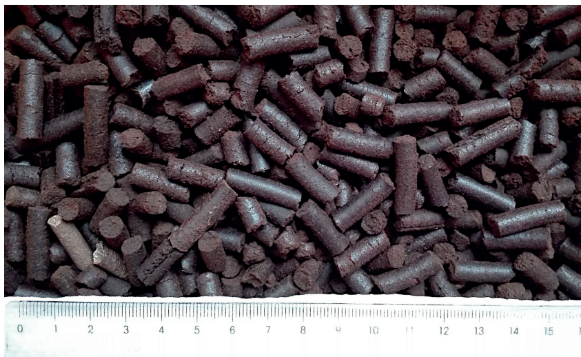
Rys. 4. Eksperymentalny granulowany nawóz organiczny z odpadów, o zawartości substancji organicznej powyżej 90%. Fot. T. Ciesielczuk
