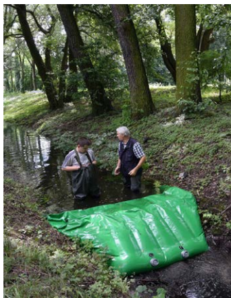
Rysunek 5. Przenośny próg piętrzący samoczynnie napełniający się wodą płynącą w rowie (Zakład Inżynierii i Gospodarki Wodnej ITP – fot. K. Krężałek)
