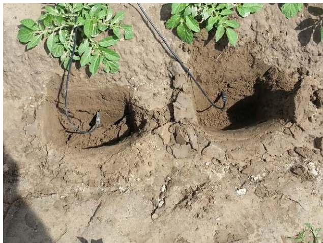
Rysunek 32. Instalacja czujników wilgotności gleby na ziemniaku, gleba piasek gliniasty mocny pylasty. (fot. R. Wawer)
