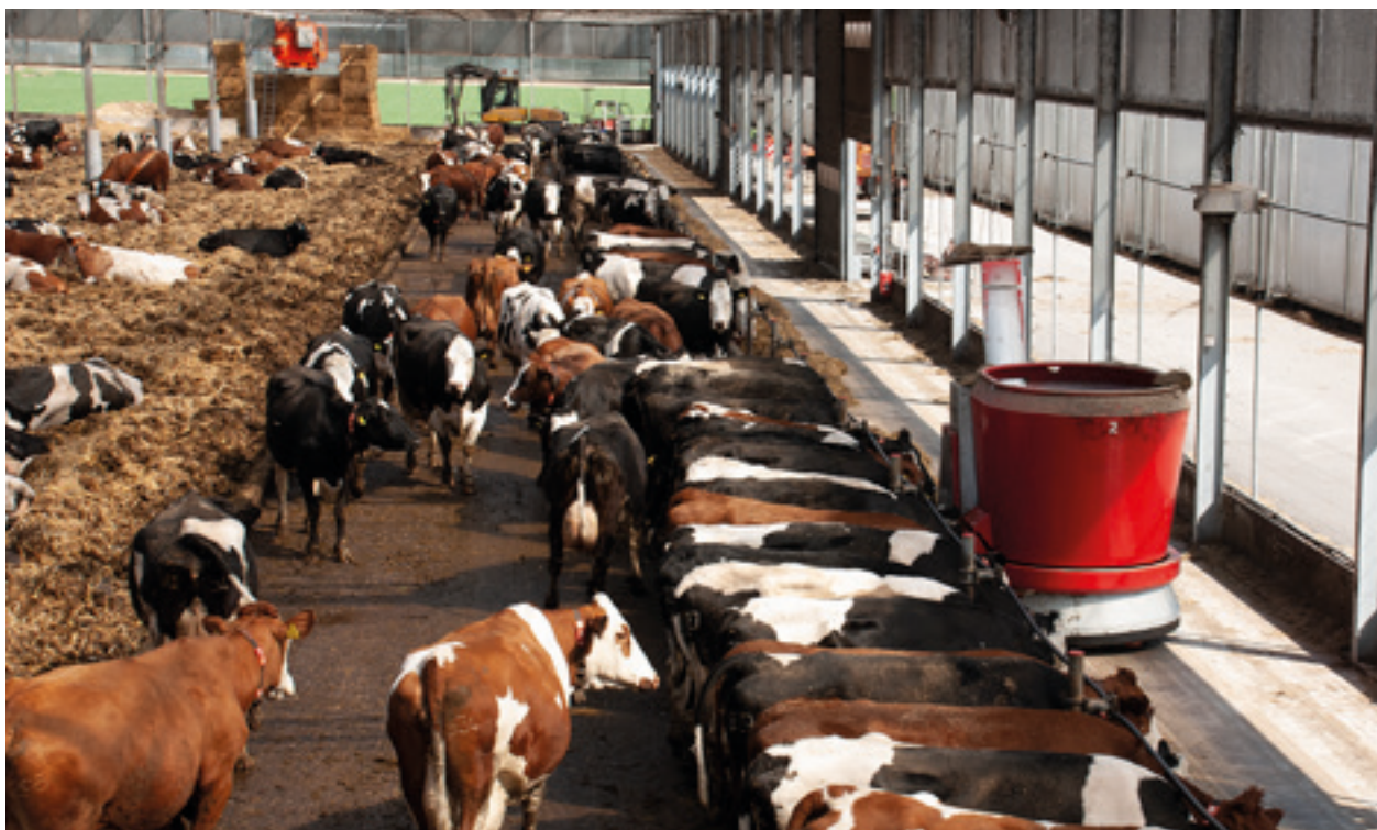
Fotografia 3.3. Samosterujący robot do sporządzania i zadawania paszy w żywieniu TMR (fot. J. Walczak)
