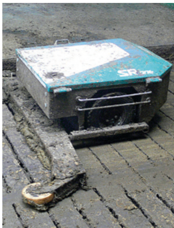
Fotografia 4.8. Robot czyszczący korytarz z podłogą szczelinową (fot. J.L. Jugowar)
