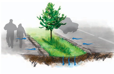
Rysunek 3. Obniżenie krawężnika pozwala na odpływ wody z ulic i chodników. Na zdjęciu — woda odpływająca z ulicy NE Siskiyou w Portland, Oregon, Stany Zjednoczone
