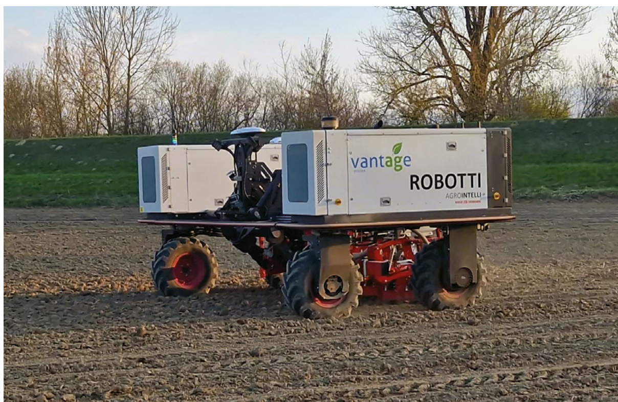
Rys. 5. Autonomiczny, wielozadaniowy robot polowy Robotti podczas siewu buraków w gospodarstwie Kępa IUNG Puławy w maju 2023 r.
