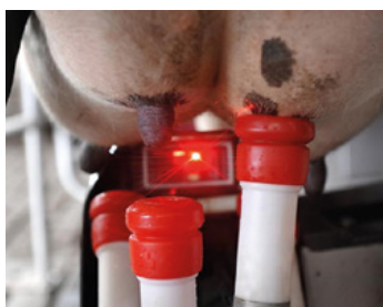
Rys. 7. Laserowy system lokalizacji strzyków
