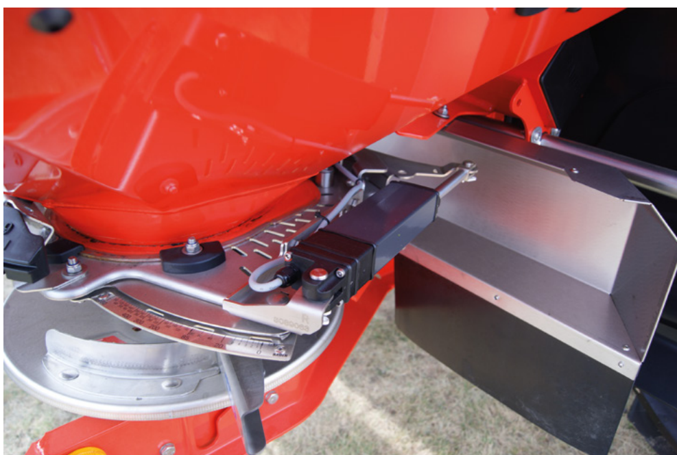
Rys. 5. Elementy robocze rozsiewacza umożliwiające automatyczną zmianę dawki wysiewu nawozów
