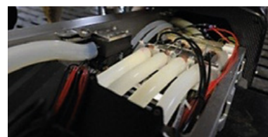
Rys. 11. System czujników do kontroli jakości mleka
