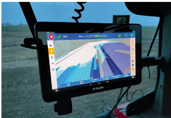
Rys. 3. Zmienne dawki dwóch składników jednocześnie – fosforu i potasu. Ekran Trimble GFX-1260 wyświetla pokrycie makroelementami. Ekran został skonfigurowany poprzez ISOBUS z głęboszem z podsiewaczem nawozów firmy UNIA
