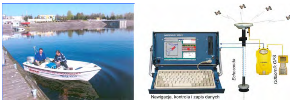
Rys. 11. Łódź pomiarowa oraz schemat aparatury użytej do pomiarów batymetrycznych
