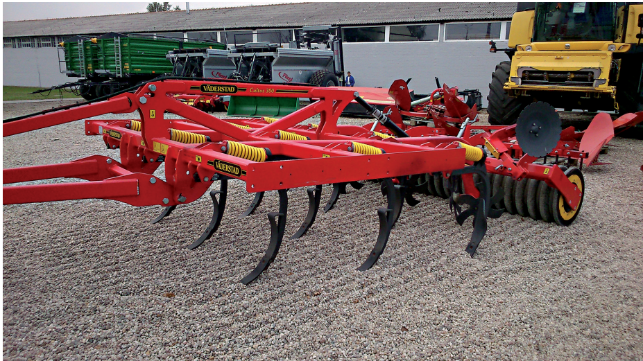
Kultywator z wałem do uprawy bezpługowej.
