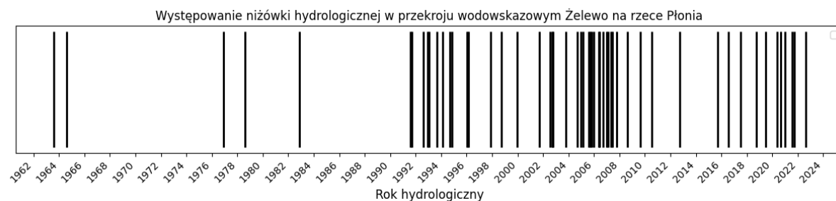
Rys. 14 Występowanie niszówki hydrologicznej w przekroju wodowskazowym Żelewo na rzece Płoni
