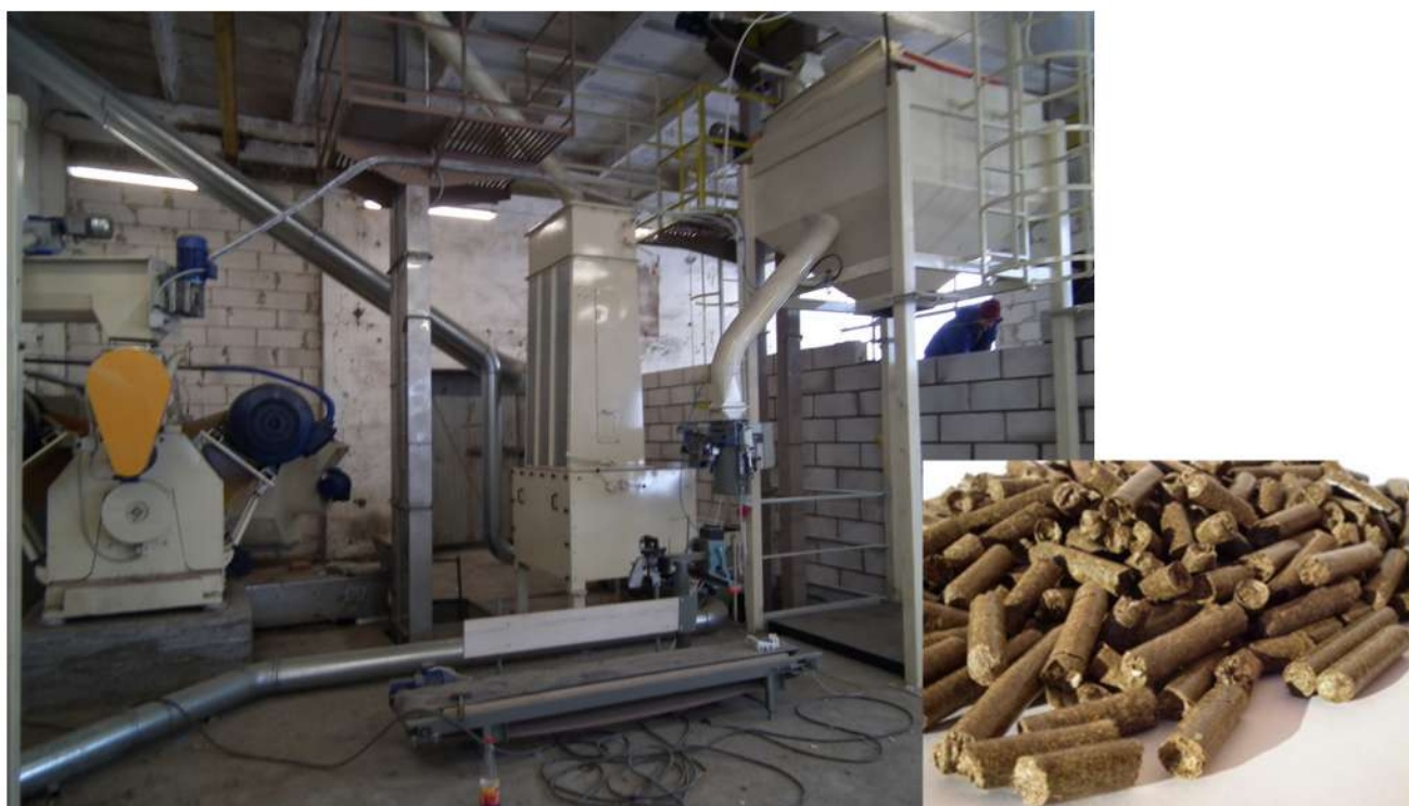
Rys. 3. Linia do produkcji i pellet OTOP z biomasy pochodzącej z terenów bagiennych. Polska, podlaskie.
